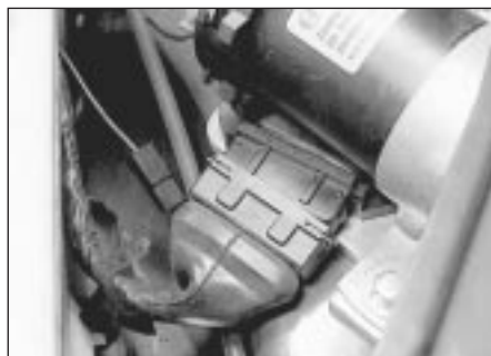
6.3 Ignition module wiring plug
